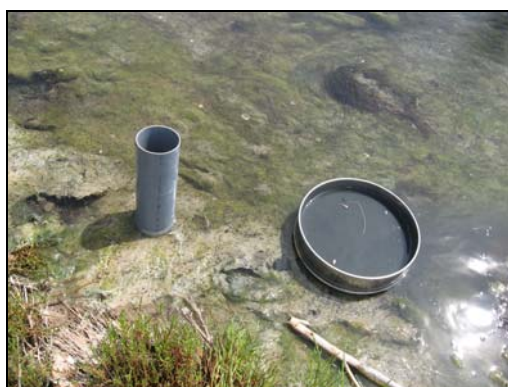
Figure 21 : Carotte et tamis pour le prélèvement de la faune benthique endogée
